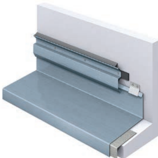
Skizze 27: Aufgesetzte Kappleiste mit Dichtband und Fugendichtstoff
